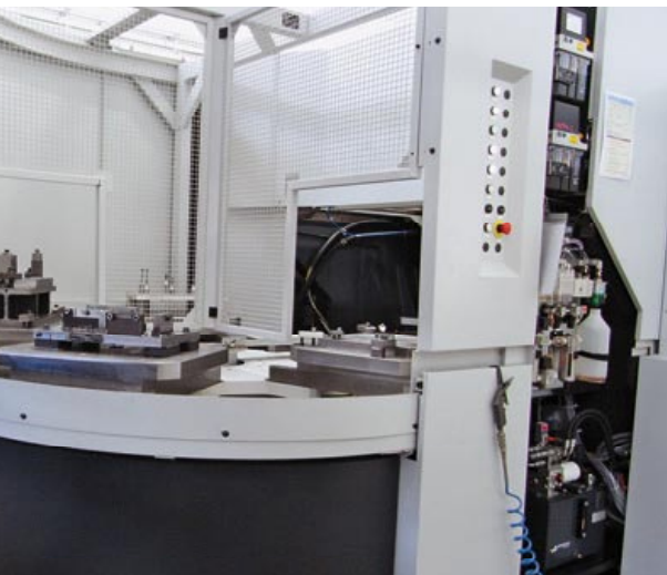
A sinistra e in basso, l'unità Mikron HPM 1000U è dotata di elettromandrino con elevata coppia, ottima per lavorare il titanio
