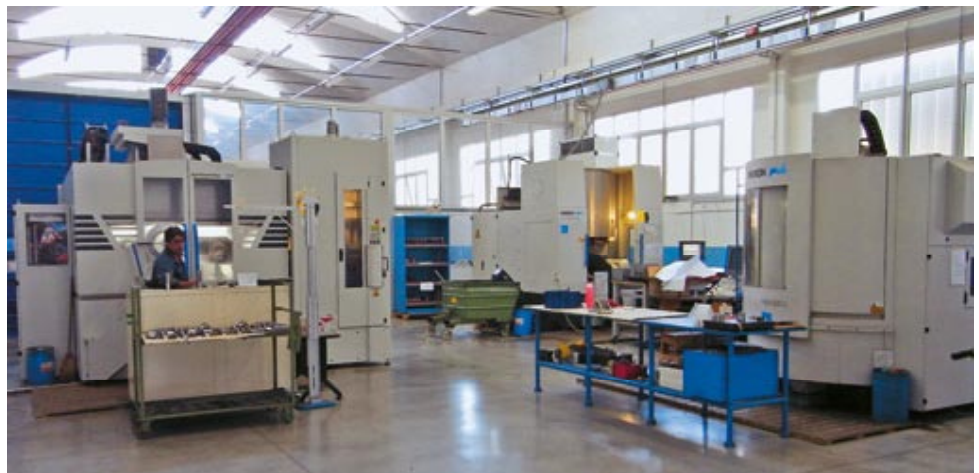
L'ampia area climatizzata nello stabilimento Novicrom dedicata alle macchine utensili a cinque assi Mikron di alta precisione e alta velocità
