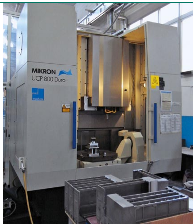
Anche la Mikron UCP 800 è una unità a cinque assi continui, equipaggiata con la tecnologia Smart Modules
