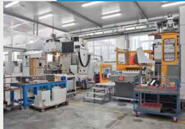
Il nuovissimo reparto delle alesatrici a controllo high-end, completamente climatizzato, è costituito da un esemplare a portale SIP GENEVOISE 8000 e da un esemplare ad asse orizzontale SIP 4000 (entrambe equipaggiate con controllo Heidenhain iTNC 530). Tali macchine garantiscono precisioni di pochi micron per volumi di lavoro sino a 1500x1000x1000mm.
