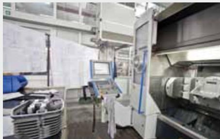
Il reparto, completamente climatizzato, è costituito da macchine a 5 assi di ultima generazione che grazie all'uso di CAM innovativi consentono la generazione di traiettorie complesse e lavorazioni altrimenti non eseguibili. E' inoltre possibile completare i particolari con minor numero di posizionamenti, a tutto vantaggio delle precisioni ottenute e delle tolleranze raggiunte.
