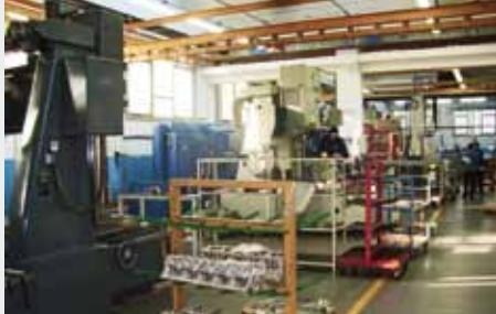
Il reparto alesatrici si compone di una serie di macchine tradizionali (Genevoise) e a controllo 4/5 assi (Sip, Dixi), sia a mandrino verticale che orizzontale, di grande precisione strutturale. Queste sono condotte da personale di lunga esperienza, specializzato nell'esecuzione di particolari unici o piccole serie che richiedono elevata accuratezza costruttiva. Il reparto è a temperatura controllata.
