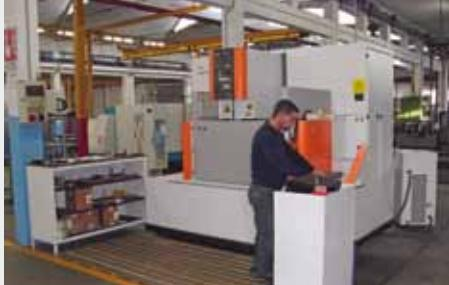
Il reparto elettroerosione contempla una moderna macchina a filo AgieCharmilles CUT30P che permette in tempi rapidi di eseguire lavorazioni di altissima precisione garantendo al contempo un'ottima finitura superficiale. E' possibile lavorare ingombri massimi di 1050x800x350mm e realizzare con estrema facilità e velocità forme difficili per le macchine tradizionali.
