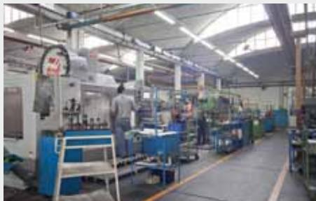
Il reparto frese e trapani contempla una vasta tipologia di macchinari, tradizionali e a controllo numerico, che permettono, sotto la conduzione di operatori competenti, sia l'esecuzione di singoli componenti meccanici sia di grandi attrezzature di lavorazione.
