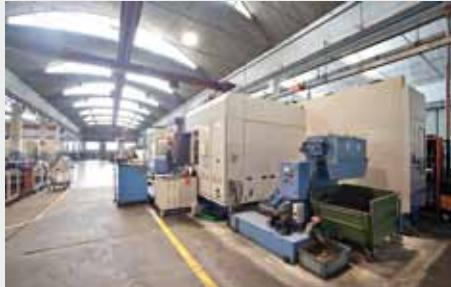
Il reparto è costituito da macchine a 4 assi controllati, pallettizzate e con volumi di lavoro fino ad 1m<sup>3</sup>. In questo reparto è possibile lavorare prodotti di ogni materiale e di forme anche complesse con altissime precisioni e, grazie alla programmazione offline e all'uso di magazzini utensili e dispositivi cambio pallet di ultima generazione, è possibile approssiare lotti di piccole-medie quantità ottimizzando i tempi di produzione e riducendo così il time to market.
