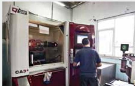
In questo reparto con macchina a 6 assi controllati provvediamo ad affilare punte, frese, alesatori e maschi. Vengono anche preparati da barrette integrali in metallo duro utensili di forme complesse su disegno.
